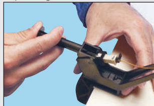
Etape 5 : alignement de la fibre
