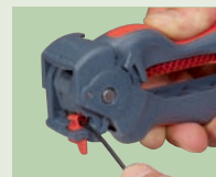
3 Insertion du conducteur et sertissage
